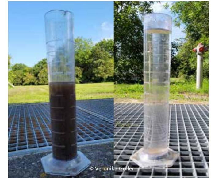
links: Schmutzwasser aus der Kanalisation, rechts: so fließt das geklärte Wasser wieder in die Zaya
