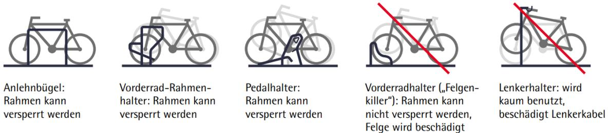
Abbildung 63: Brauchbare und unbrauchbare Radständermodelle <sup>88</sup>
