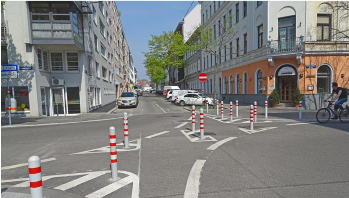
Abbildung 35: Beispiel für eine Diagonalsperre in Wien nach dem Prinzip der „selektiven Durchlässigkeit“ (Durchquerung nur für Radfahrer:innen und Fußgänger:innen möglich) <sup>45</sup>
