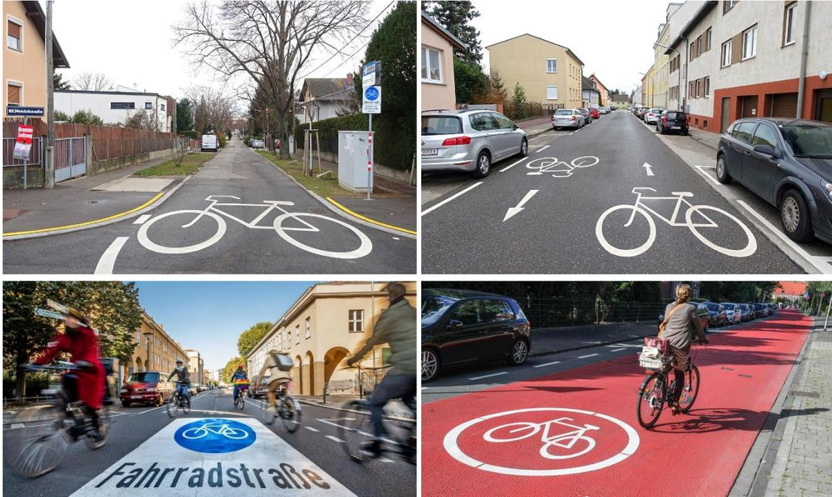
Abbildung 52: Good Practice-Beispiele für die Kennzeichnung von Fahrradstraßen
