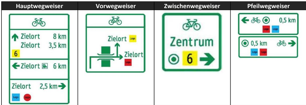
Abbildung 59: Typen von Radverkehrswegweisern <sup>83</sup>
