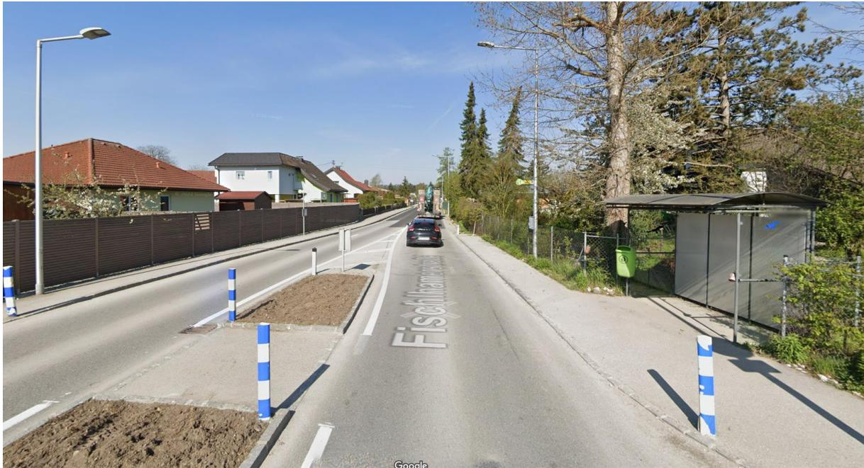
Abbildung 73: Kombination von Bushaltestellen auf der Fahrbahn mit Mittelinseln als Querungsmöglichkeit <sup>104</sup>
