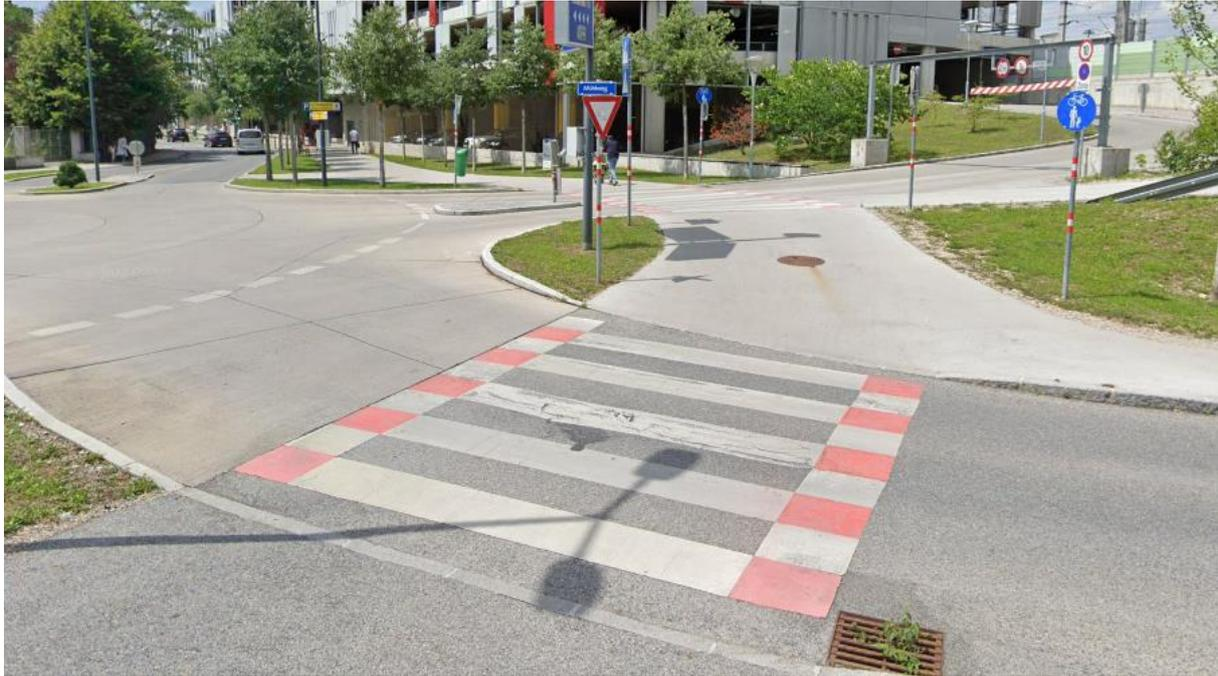
Abbildung 49: Kombination von Schutzweg und Radfahrerüberfahrt bei kombinierten Geh-/Radwegen <sup>64</sup>
